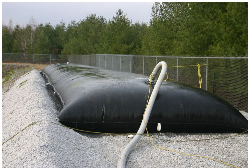
Mynd 10.7: Geotube söfnunarpoki.[28]
